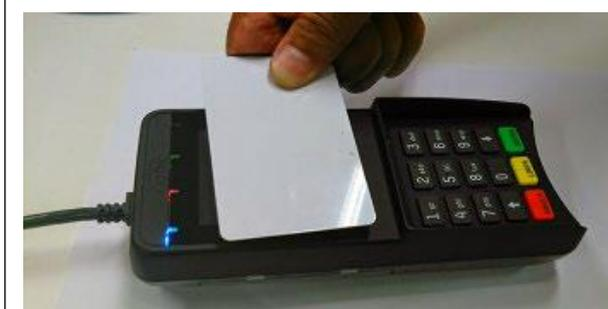
Se o cartão for sem contato, o PPC930 poderá ler seus dados utilizando tecnologia NFC. Os LEDs são utilizados para sinalizar o status da leitura.
