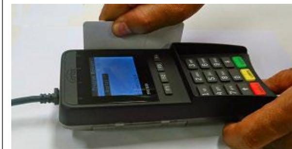
Se for utilizado um cartão com banda magnética, este poderá ser lido no leitor existente na lateral do PPC930.
